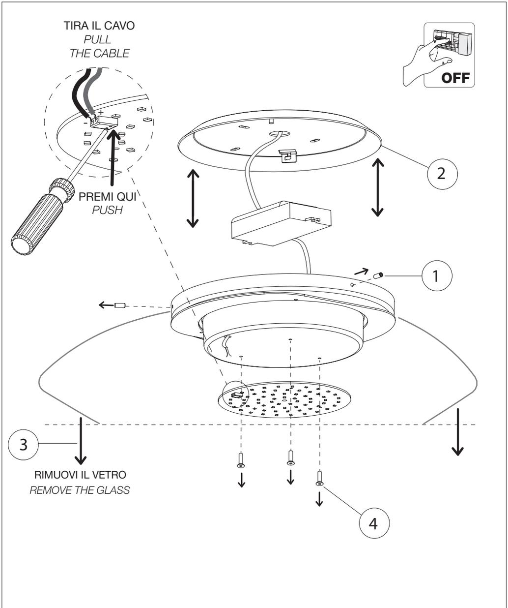
Segui le istruzioni di montaggio a ritroso per avere più chiare le operazioni di smontaggio
